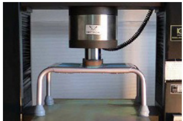
図4 金属製の踏み台における対荷重実験風景 120kgの負荷にて1万回の対荷重実験を通過し 耐久性を証明。
