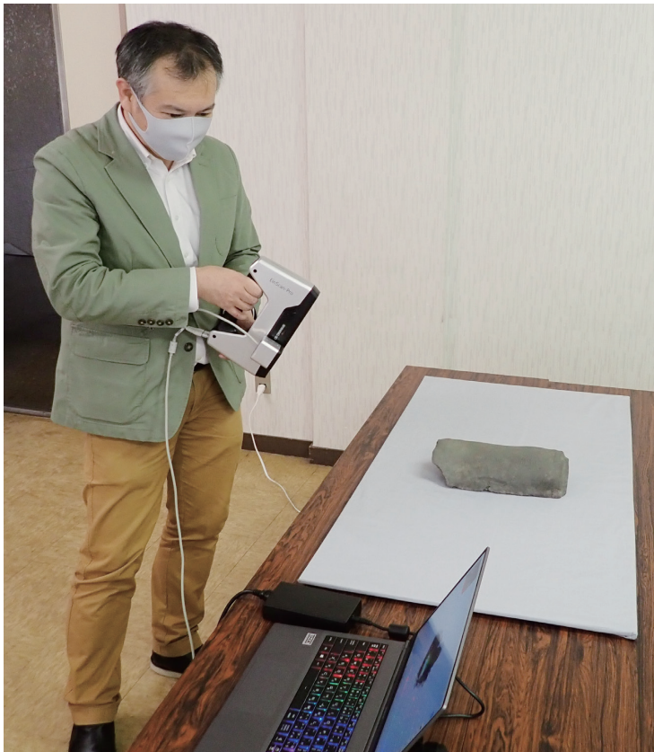
写真2：現存する屋根瓦を3Dスキャンする倉田准教授
