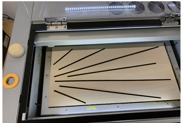
写真9 レーザーカッターで木型を制作する様子
