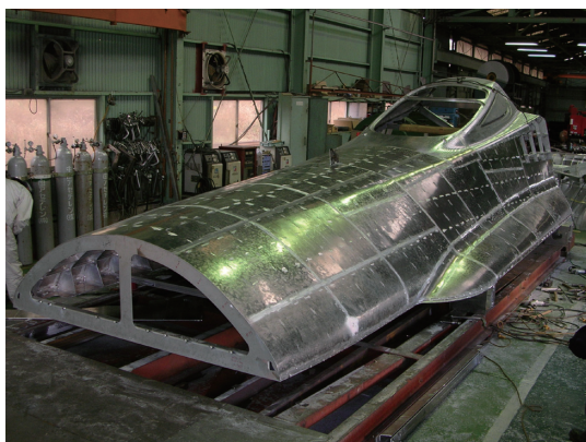
手仕事による新幹線の板金加工
