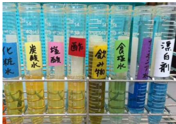
Fig.2 BTB 溶液による各種溶液の性質の確認
