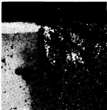
図10 セラミック工具の二次的摩耗例
