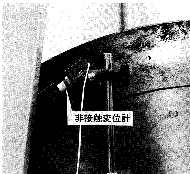
図 3 ねじり振動の測定方法
