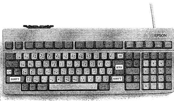
図1. ペダル併用キーボード。白いキーにペダルスイッチを併用した。
