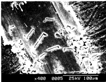
図13. SiC/Al (①方向)の切削面
