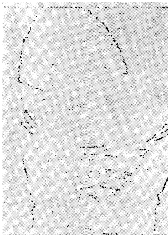
出力画 3・4 色差による輪郭線抽出(4) 直流レベルをオフセット (1.0V) \theta=0.05 , ISL=7
