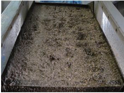
写真7 実験終了後（裸地：50mm/h）
