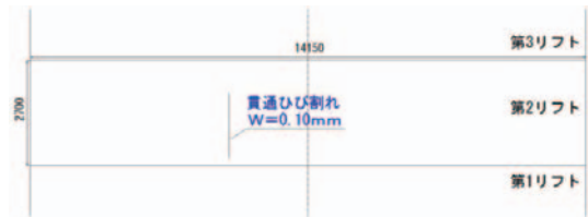
図-18 ひび割れ発生位置
