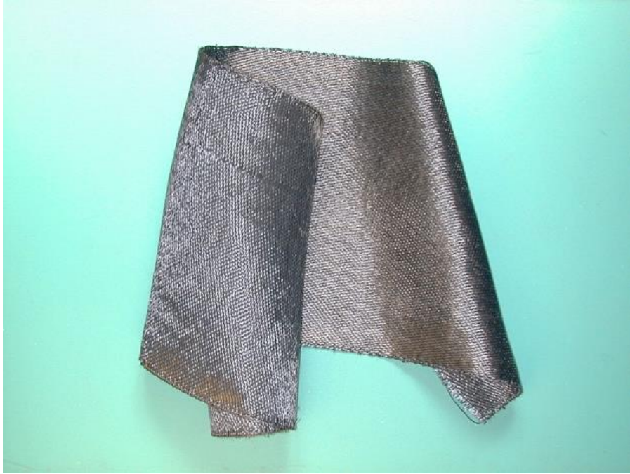
Fig. 2.4.3. Satin fabric of Tyranno SA fibers
