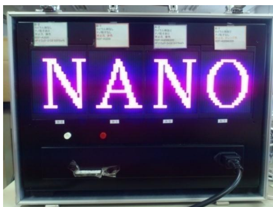
図 5-21 \text{PyCyD-ZrO}_2 ナノ粒子を分散した FSC-LCD 試作機
