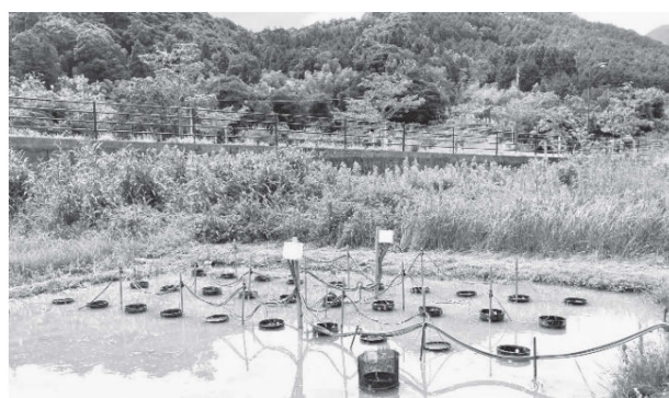
Fig.16. 田圃南側に設置した電池群(32個)
