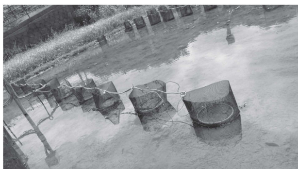
Fig.10. 田圃に埋設した微生物燃料電池群
