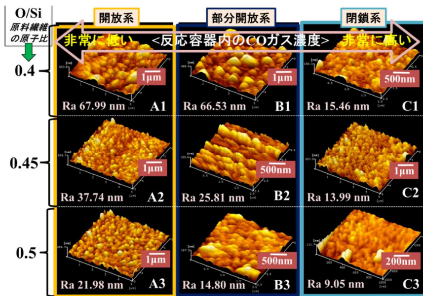
図 2.5 得られた繊維の原子間力顕微鏡による表面平滑性の評価
