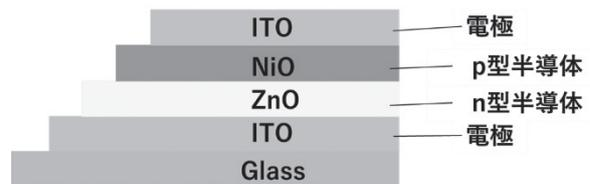
Fig.1 透明太陽電池の構成例
