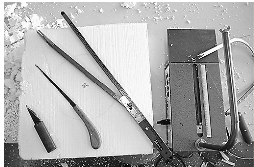
写真1 作業機材：スチロールカッター・小刀・ 回し引きのこ・コンパス
