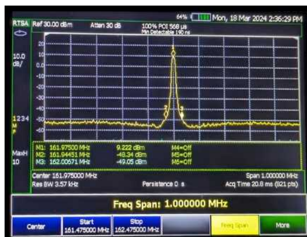
図4 条件 周波数 : 161.975MHz / Type : AIS (GMSK) / Power : 1W / ATT : -20dB
