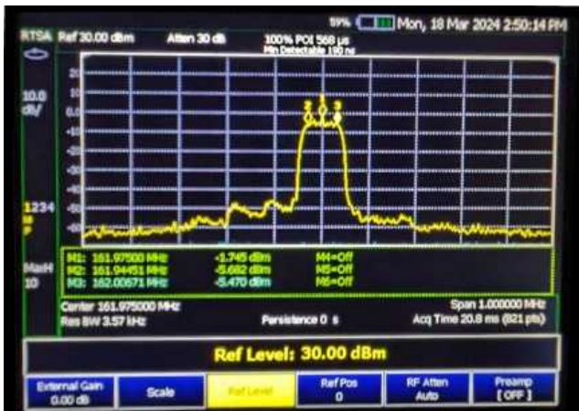
図 8 条件 周波数 : 161.975MHz / Type : VDE (TER Link ID17) / Power : 12.5W / ATT : -40dB
