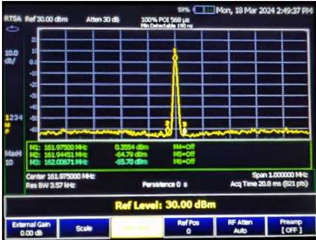
図 7 条件 周波数 : 161.975MHz / Type : AIS (GMSK) / Power : 12.5W / ATT : -40dB
