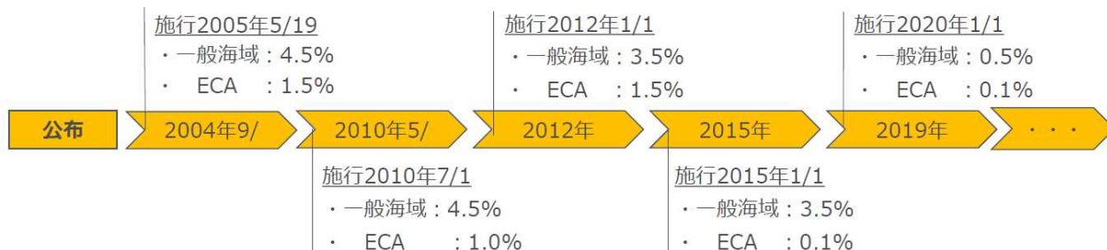
図4 「海洋汚染等及び海上災害の防止に関する法律」による燃料油中の硫黄分濃度規制(同法は「海洋汚染及び・・・」であったが、船舶からの排出ガス規制が加わり、「海洋汚染等及び・・・」となっている。)
