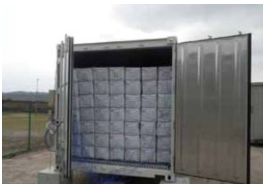
図4 冷凍コンテナの内の貨物の積み付け状態
