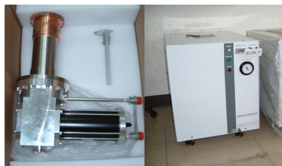
冷凍機 RF90S コンプレッサー C300G
