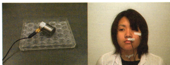
図2 加速度検出器と取り付け位置
