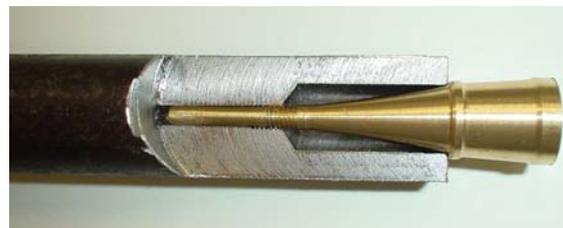
写真13 縦軸受け皿用治具の断面
