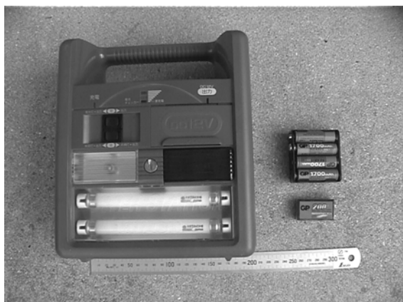
写真1 電源として使用する電池
