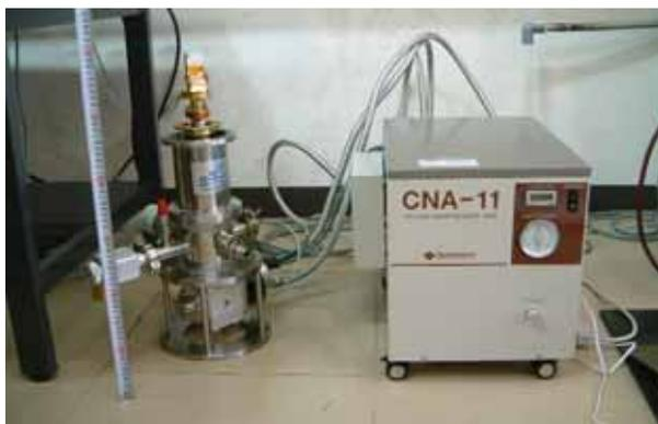
図 1 . GM 冷凍機の外観写真
