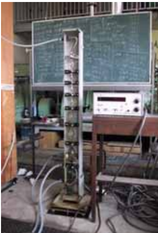
写真2 ビューレット式燃料消費量計測器 (小野測器 FC-140)
