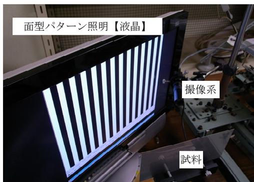
図8 表示デバイスを用いた実験装置
