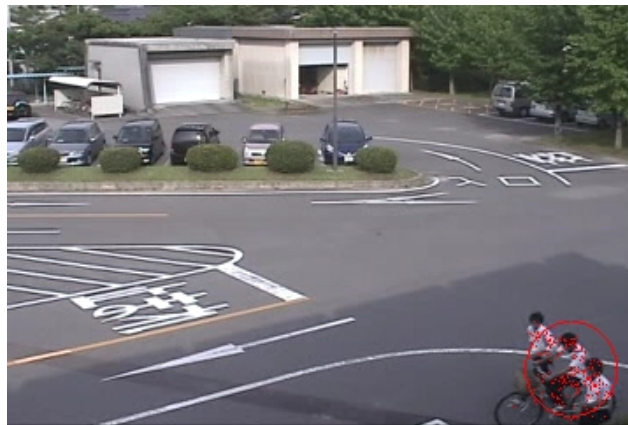
図 10 物体が近接した状態で進入してきた場合の検出結果
