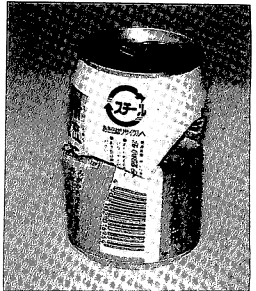
(d) Buckling of 2P(B) can
