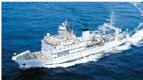
図7. 漁業練習船第4代耕洋丸. 総トン数2,352 tons、全長87.59 m、平成19年6月竣工。
