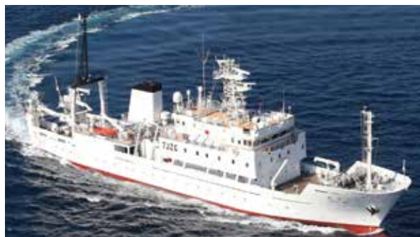
図9. 漁業練習船第4代天鷹丸. 総トン数995 tons、全長64.67 m、平成29年10月竣工。
