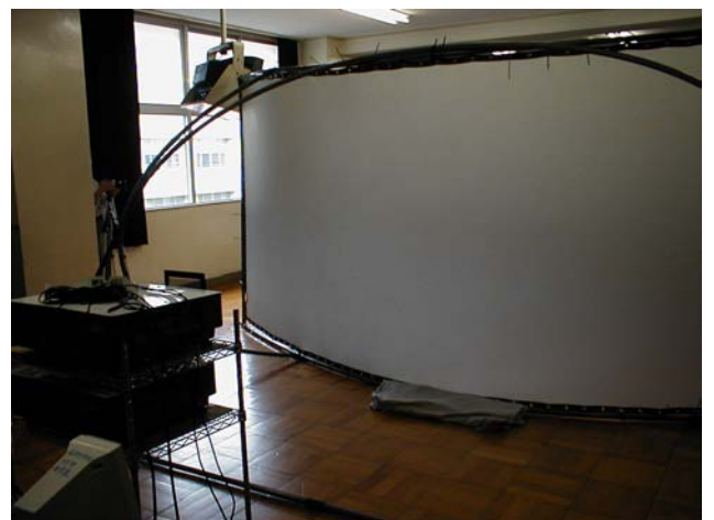
図5 左右の目に対応した偏光映像を投影する 2つのプロジェクター
