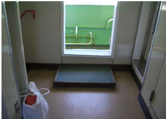
写真1 船内の段差の例 (つばき2)
