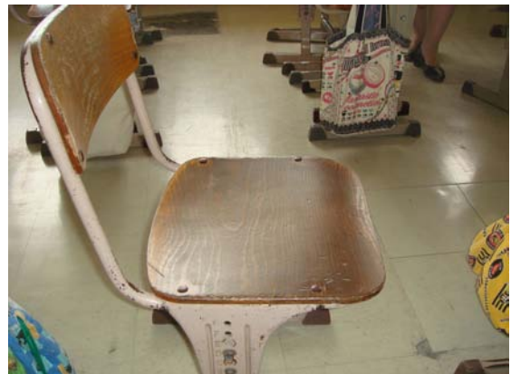
図-10 椅子座面表面の変色
