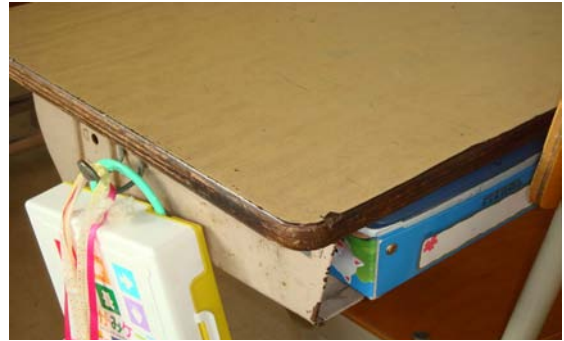
図-8 天板の剥離、折損、打痕
