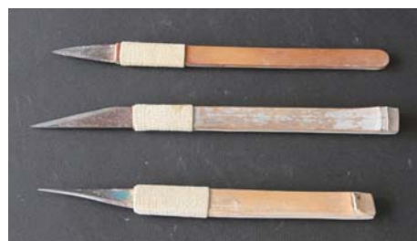
図3-5 粘土を切る道具はばり（筆者手製）
