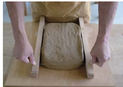
図2-5 タタラ板（粘土塊左右に重ねてある木の板＝定規のようなもの）によるタタラ作り
