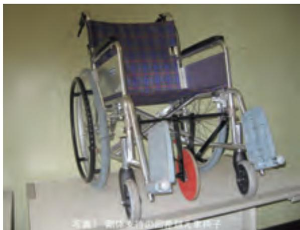
写真1 剛体支持の段差越え車椅子
